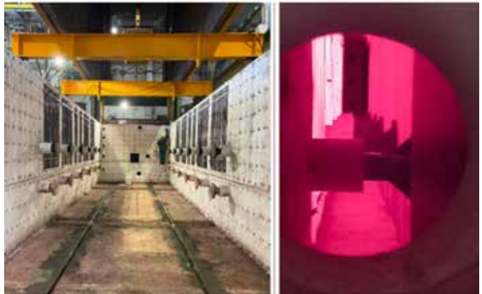
圖 7 雙能源（瓦斯與電能）鍍鋅爐
