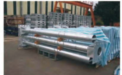
高鐵輸配電鋼架
