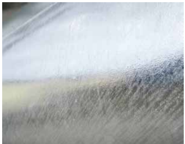
圖 4 SS400-HDG 熱浸鍍鋅後表面狀況
