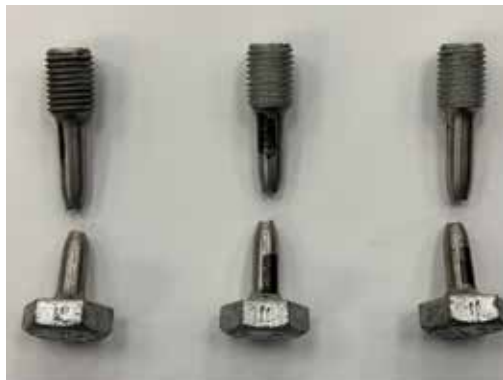
圖 7 Type 1 熱浸鍍鋅高強度螺栓試片拉斷情形，有頸縮現象
