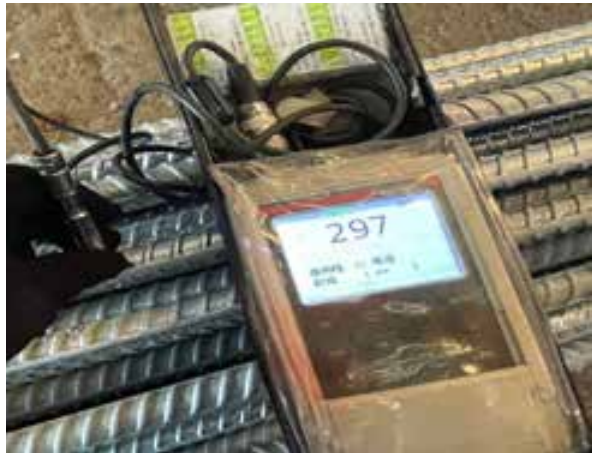
圖 8 鋼筋鍍鋅膜厚度量測 ( 1\mu\text{m} = 7.2\text{g}/\text{m}^2 )
