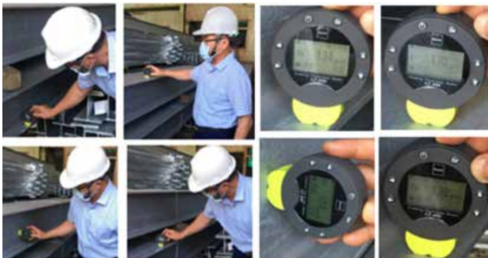
圖 5 鋼梁不同區位的鍍鋅膜厚度量測紀錄圖
