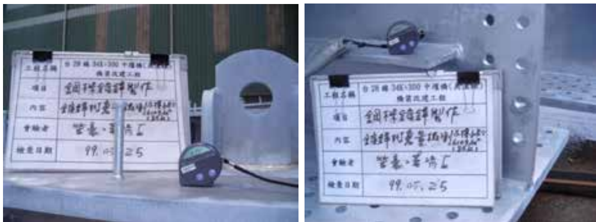
圖 15 鋼構建材鍍鋅檢測
