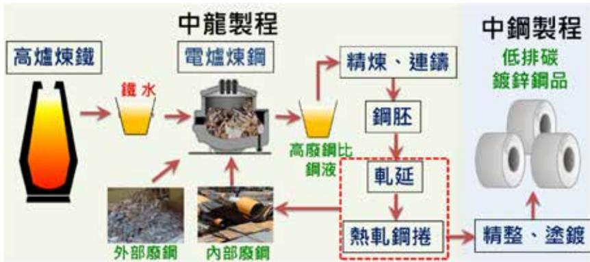
圖 4 中鋼集團電爐添加鐵水製程生產流程
