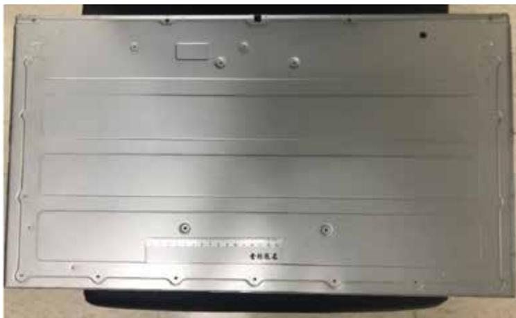
圖 5 加工後的 RC60 鍍鋅鋼捲製成的 LCD 背板的外觀
