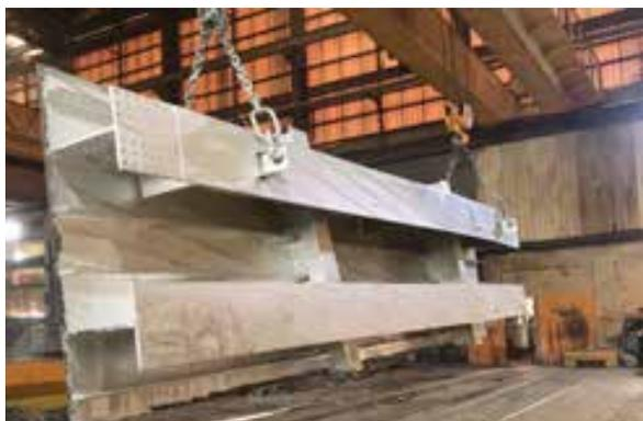
圖 14 水冷作業
