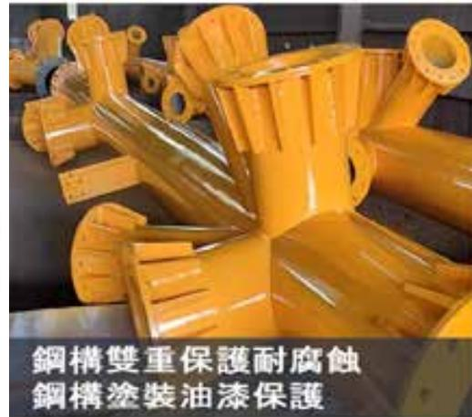
圖 13 鋼管單元構件熱浸鍍鋅與油漆保護塗裝
