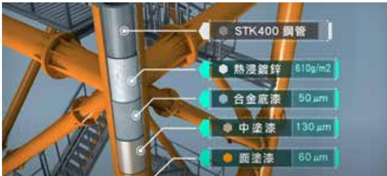
圖 9 利用熱浸鍍鋅與油漆塗裝複合式保護鋼構架
