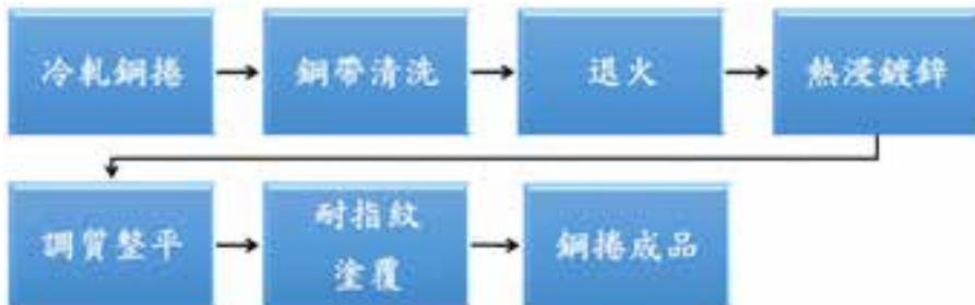
圖 3 GI 耐指紋鋼捲生產流程。
