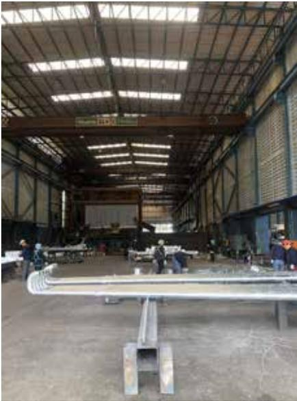
採直線型設計，廠房寬度約鍍鋅爐長度的兩倍
